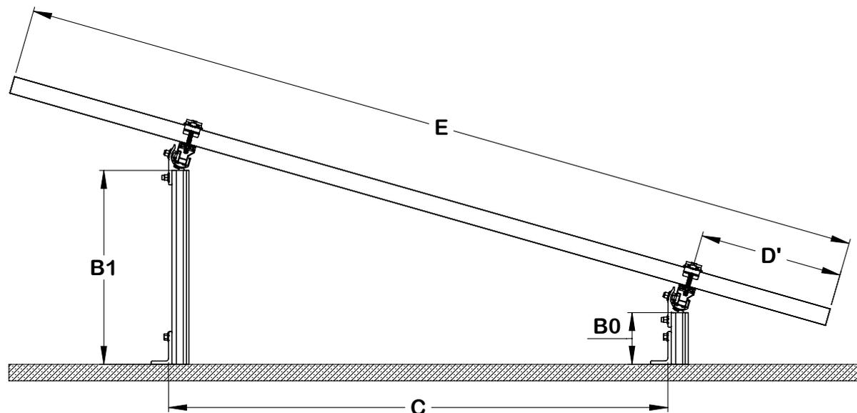
Figura 1 Dimensiones de ensamble para sistema Simple Tilt.
