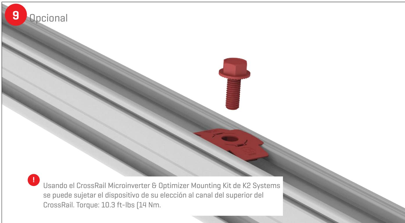
! Usando el CrossRail Microinverter & Optimizer Mounting Kit de K2 Systems se puede sujetar el dispositivo de su elección al canal del superior del CrossRail. Torque: 10.3 ft-lbs [14 Nm].
