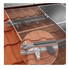
Com alguns componentes adicionais, o K2 Buddy pode agora também ser instalado em telhados com inclinações de 15° a 45° em combinação com o gancho de telhado K2 SingleHook 3S e o K2 SingleRail 36 numa única camada.
