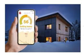
A aplicação K2 Buddy oferece uma interface de utilizador intuitiva que mostra o estado atual do módulo tanto ao instalador como ao proprietário do sistema. Se os valores de carga forem demasiado elevados, é enviada uma notificação push para o instalador e para o proprietário do sistema.
