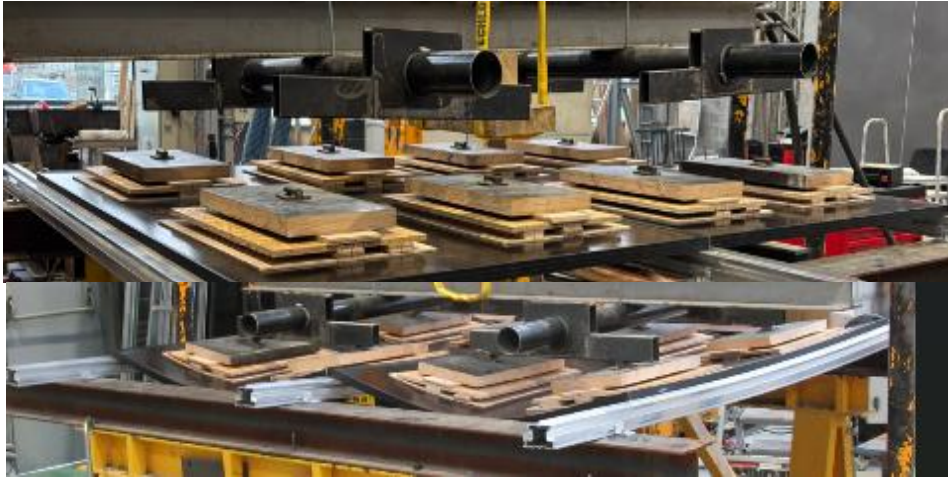
Essais statiques – Les cales en bois ont distribué les charges
