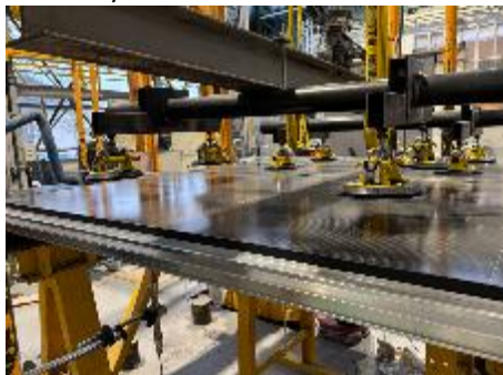
Essai de fatigue (traction + compression) par ventouses
